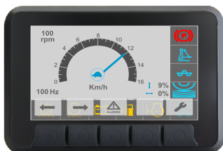
Fig. En la parte central de la pantalla se muestra la selección (liebre, deslizamiento del tambor, deslizamiento de ruedas o tortuga).
