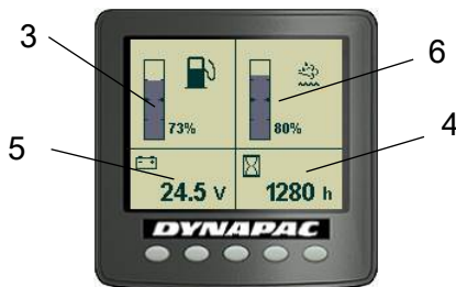
Fig. Statusbild 3. Bränslenivå 4. Driftimräknare 5. Voltmätare 6. Ureanivå
