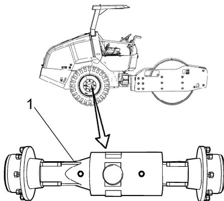
**Abb. Ölstandskontrolle - Differentialgehäuse**
