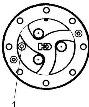
**Abb. Planetengetriebe / Stellung zum Ölauffüllen**
