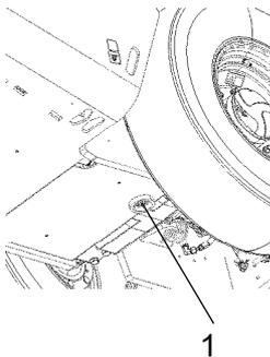
**Abb. Hydrauliköltank, Unterseite
