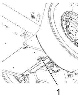
Abb. Hydrauliköltank, Unterseite
