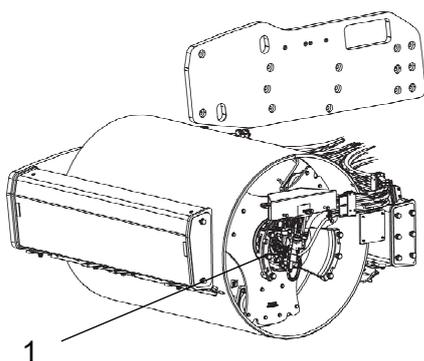
**Abb. Ölwechsel – Bandagengetriebe**
