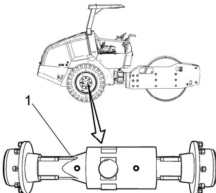
**Abb. Ölstandskontrolle - Differentialgehäuse**
