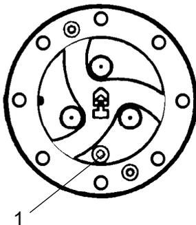
**Abb. Planetengetriebe / Stellung zum Ölablassen**
