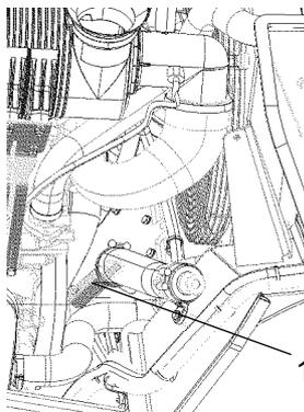
**Abb. Schauglas, Hydrauliköltank**
