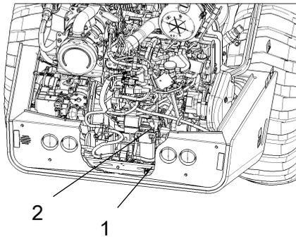
Die Ablassschraube (1) unten am Kraftstoff-Vorfilter lösen.
