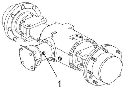
**Abb. Ölstandskontrolle - Ritzelgehäuse**
