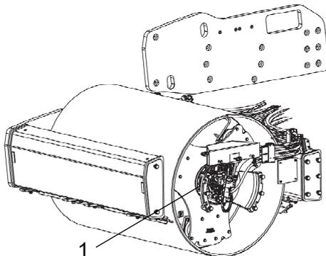
**Abb. Öl einfüllen – Bandagengetriebe**
