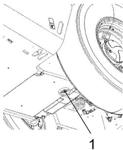
Abb. Hydrauliköltank, Unterseite
