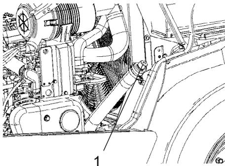
Tankdeckel/Entlüftungsfiter (1) öffnen, so dass kein Überdruck mehr im Tank herrscht.
