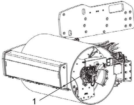
**Abb. Öl einfüllen – Bandagengetriebe**
