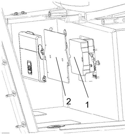
Die Steuerungseinheit (ECU) (1) befindet sich hinter der Abdeckung (2) unter dem Fahrersitz.
