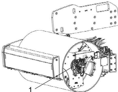
**Abb. Öl einfüllen – Bandagengetriebe**
