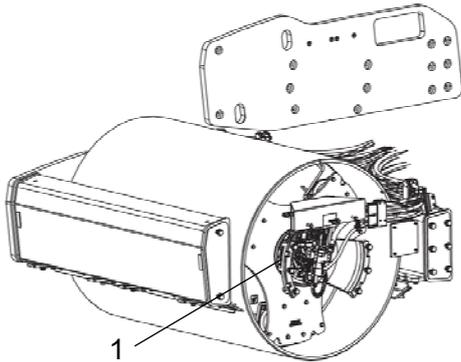
**Abb. Öl einfüllen – Bandagengetriebe**
