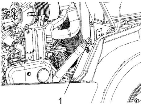
Tankdeckel/Entlüftungsfilter (1) öffnen, so dass kein Überdruck mehr im Tank herrscht.
