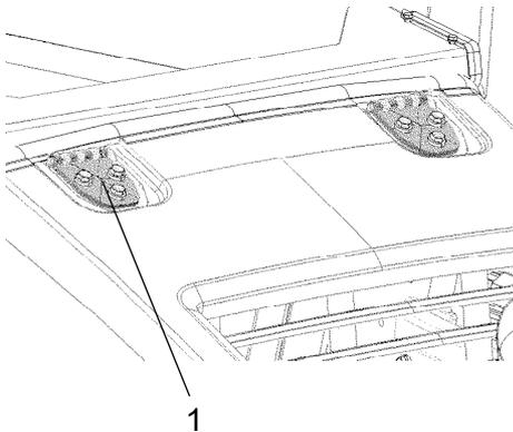
Scharniere der Motorhaube (1) mit Schmierfett schmieren, übrige Gelenkpunkte und Hebel mit Öl schmieren. Siehe Schmiermittelspezifikation.
