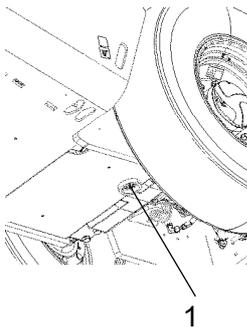
**Abb. Hydrauliköltank, Unterseite
