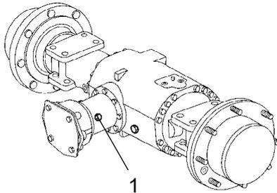
Abb. Ölstandskontrolle - Ritzelgehäuse
