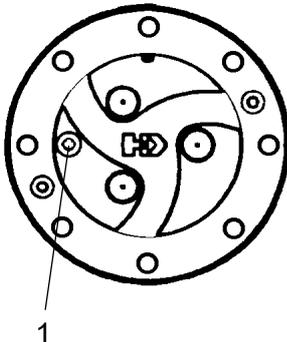
Die Walze so stellen, dass die Schraube (1) im Planetengetriebe auf "9:00 Uhr" steht.
