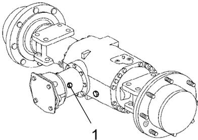
**Abb. Ölstandskontrolle - Ritzelgehäuse**
