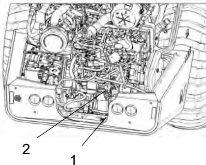
Die Ablassschraube (1) unten am Kraftstoff-Vorfilter lösen.
