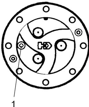
**Abb. Planetengetriebe / Stellung zum Ölauffüllen**
