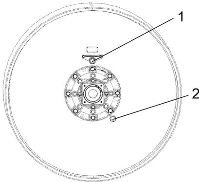
Falls nötig die Öleinfüllschraube (1) lösen und bis zur Hälfte des Schauglases (2) auffüllen.
