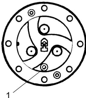
**Abb. Planetengetriebe / Stellung zum Ölablassen**
