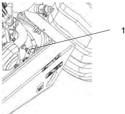
Die Pumpe zum Freigeben der Bremsen befindet sich am Ventilkopf, welcher hinten im Motorraum untergebracht ist.
