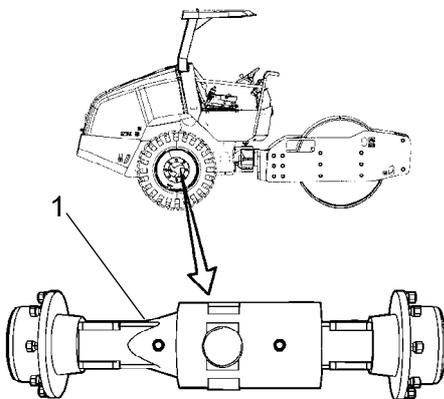
**Abb. Ölstandskontrolle - Differentialgehäuse**
