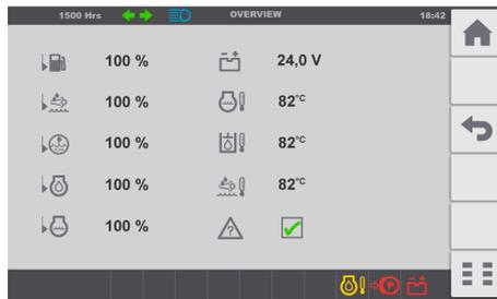
« VUE D'ENSEMBLE » - Écran de vue d'ensemble avec les niveaux, batterie/niveau de charge et les températures.
