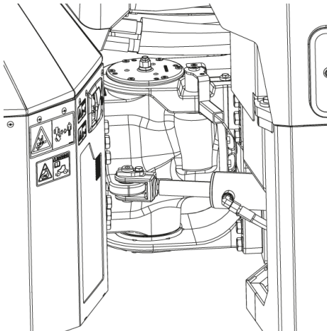
Εικ. Ένωση συστήματος διεύθυνσης
