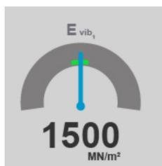
Fig. Compattometro (DCM) con Evib
