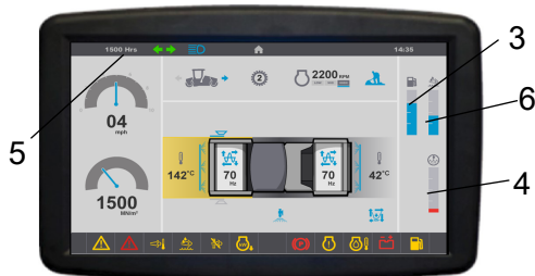
Rys. Ekran stanu 3. Poziom paliwa 4. Poziom wody 5. Licznik motogodzin 6. Poziom mocznika
