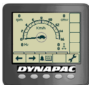
Obr. Výběr se zobrazí uprostřed displeje (želva, otáčení válce, otáčení kol či zajíc).
