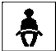
Si la ceinture de sécurité n'est pas bouclée, une image d'avertissement apparaît à l'écran et un avertisseur sonore retentit pour rappeler au conducteur qu'il doit utiliser la ceinture.
