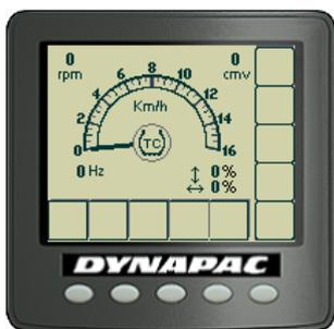
**Fig. L'écran indique si le Contrôle de la traction (antipatinage) est activé ou débrayé**
