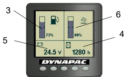
Εικ. Εικόνα κατάστασης 3. Στάθμη καυσίμου 4. Ωρομετρητής 5. Βολτόμετρο 6. Στάθμη ουρίας
