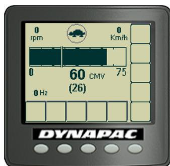
Fig. Display del compattometro (display CMV)
