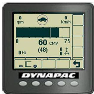
La schermata valore compattometro nel display darà all'operatore tutte le informazioni richieste durante la compattazione: regime del motore, posizione del cambio, frequenza e inclinazioni, nonché il valore CMV effettivo e il limite impostato tra parentesi. Utilizzare i pulsanti sotto al display per impostare il limite. La scala cambia automaticamente, in funzione della lettura CMV.
