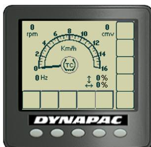
**Fig. Il display mostra se il TC (anti-rotazione) è attivato o disattivato**
