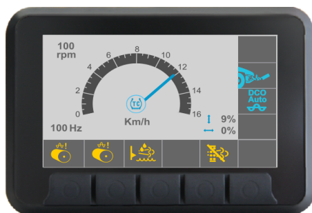
Rys. Na wyświetlaczu widać, czy kontrola przyczepności (system antypoślizgowy) jest włączona, czy wyłączona
