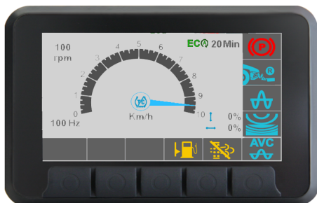
Rys. EcoSave – Widok główny/Widok roboczy
