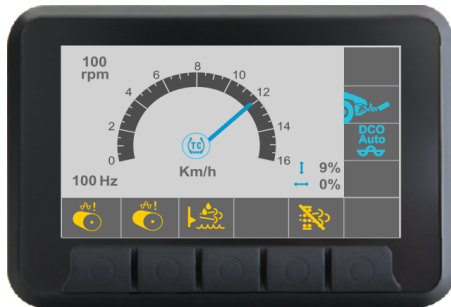
Fig. En la pantalla se muestra si se ha activado o desactivado el TC (antideslizamiento)
