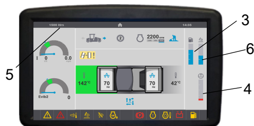
Fig. Statusbild 3. Bränslenivå 4. Vattennivå 5. Driftimräknare 6. Ureanivå
