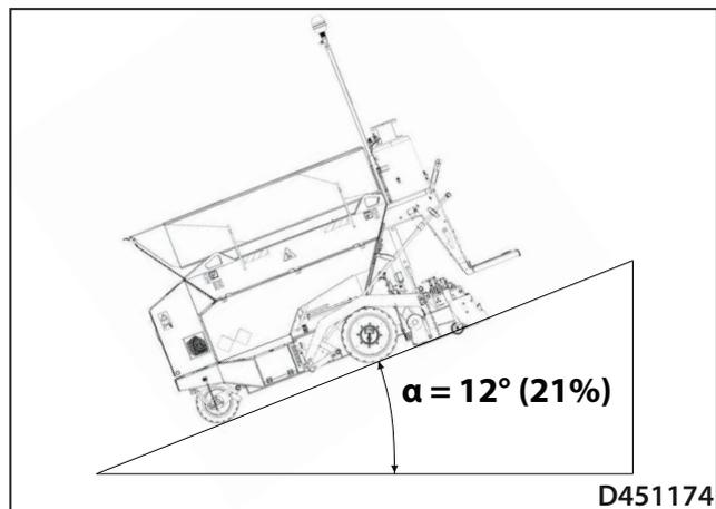
Снижение машины с полной загрузочной воронкой (плита в нижнем положении).
