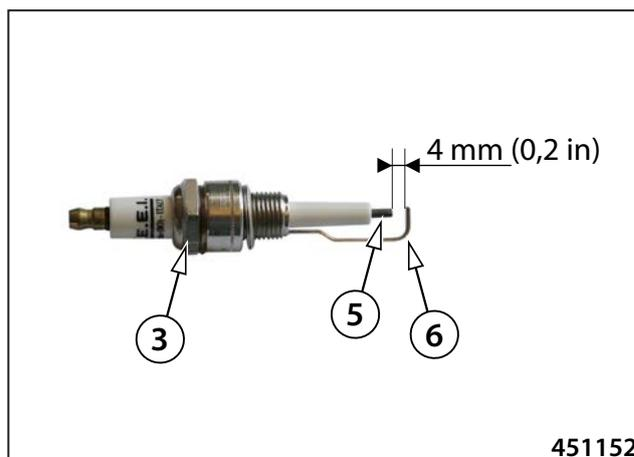
**Регулировка положения газового пламени:**
