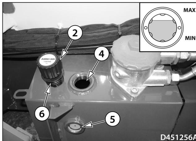
**Процедура замены фильтрующего элемента гидравлического масла:**
