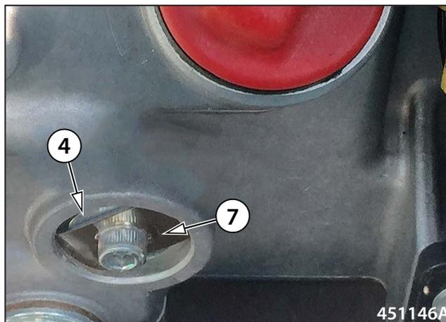
**Процедура проверки количества масла в двигателе:**
