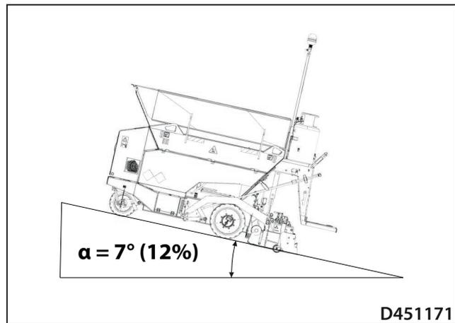
Скороподъемность машины с полной загрузочной воронкой (плита в нижнем положении).
