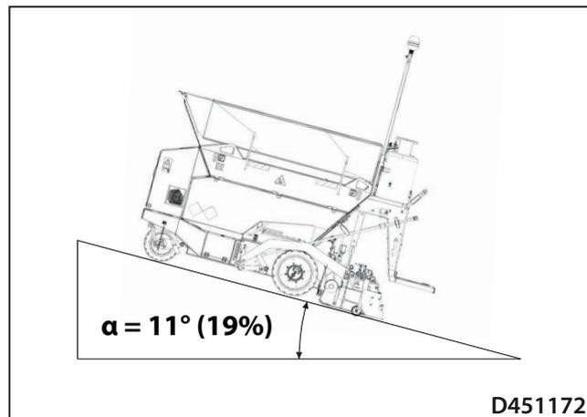
Снижение машины с пустой загрузочной воронкой (плита в нижнем положении).
