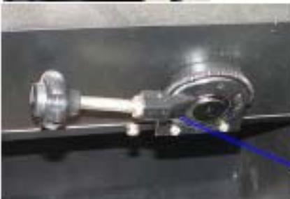
在启动前，确保油门位于图示的怠速状态（该状态为左侧操纵，右侧操纵的手柄正好相反）。
