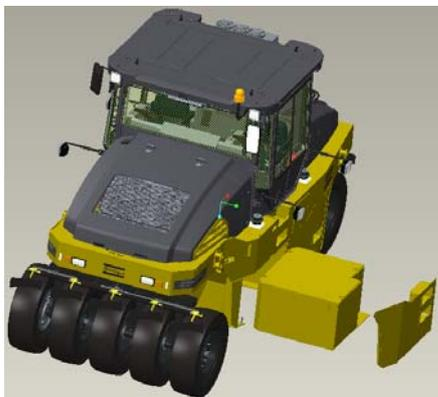
拆掉左前盖板（1），左后盖板（2），右前盖板（3）及右后盖板（4）。
