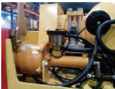
图示. 制动液存储箱
