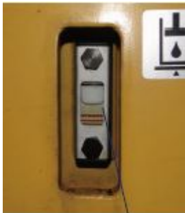
图示. 液压油箱 1. 油位观察视镜
