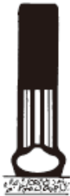
图示. 较低地面压力，接触区域较大
