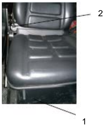
图示 2. 操作者座椅 1. 前后调节手柄 2. 靠背仰角调节手柄
