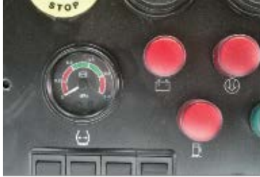
图示 1. 操作台 - 气压表
