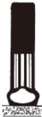
图示. 较低地面压力，接触区域较大
