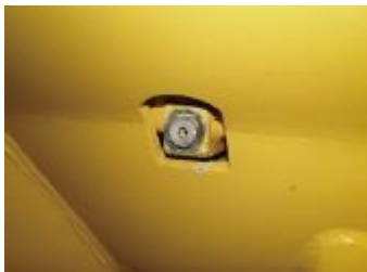
图示. 液压油箱放油堵
