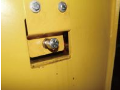
图示. 机油放油堵
