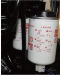
图示. 柴油过滤器 1. 放水口
