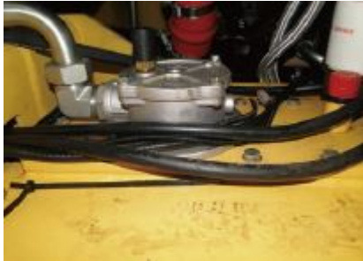
图示. 液压油过滤器
