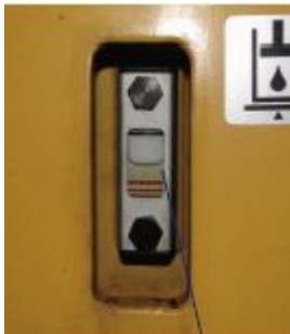
图示. 液压油箱 1. 油位观察视镜
