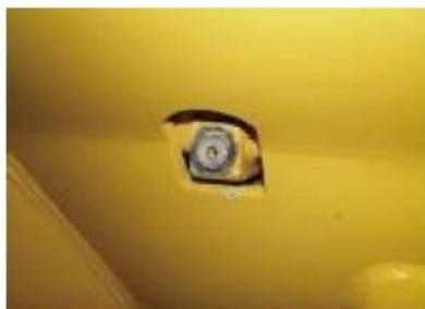
*Fig. Bouchon de vidange du réservoir hydraulique*
