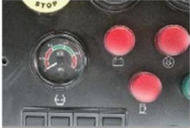
*Fig 1. Tableau de bord - Manomètre.*
