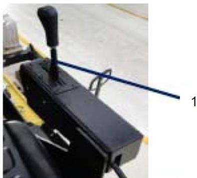
Pour démarrer la machine, le levier avant/arrière doit être en position neutre, au milieu.
