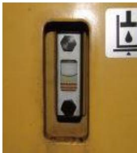
*Fig. Réservoir hydraulique*
