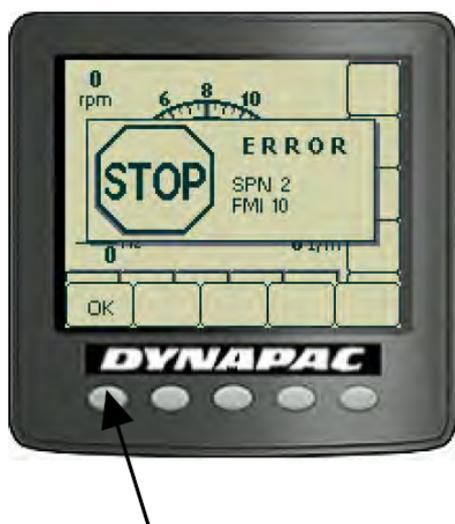
Quando um alarme do motor é ativado, a indicação aparecerá no visor. Ele será emitido pelo ECM do motor, o qual faz o monitoramento das suas funções.
