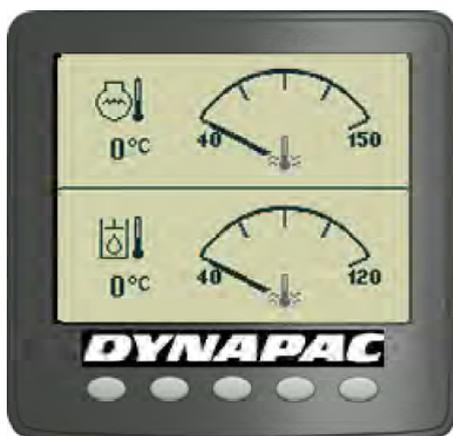
A tela de temperatura indica a temperatura do óleo do motor (parte superior da tela) e do óleo hidráulico (parte inferior). Os valores são indicados em graus Celsius ou Fahrenheit, dependendo da opção do sistema de medidas.
