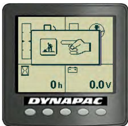
Ao tentar ativar o cortador de bordas (opcional) com a máquina no modo de velocidade alta, o visor exibirá o modo de velocidade baixa por alguns segundos.
