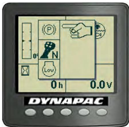
Ao tentar ligar a máquina sem ter realizado até três das condições necessárias para isso, as condições faltantes serão exibidas na tela. É preciso configurá-las antes de ligar a máquina.
