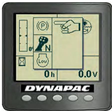
Quando si cerca di avviare la macchina senza aver impostato una, due o tre delle condizioni richieste per farlo, le condizioni mancanti vengono visualizzate sul display. È necessario impostare le condizioni mancanti prima di poter avviare la macchina.
