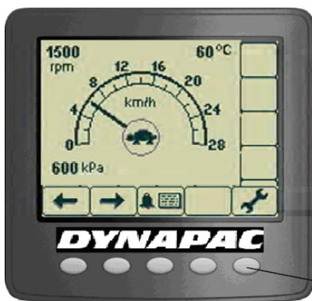
Premendo uno dei pulsanti di selezione, appare un campo di menu. Resta visibile per un breve intervallo, per poi svanire in dissolvenza una volta effettuata una selezione. Premendo uno dei pulsanti di selezione (1) viene nuovamente visualizzato un campo di menu.
