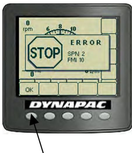
Quando viene attivato un allarme motore, esso appare sulla schermata. L'allarme viene inviato dalla centralina del motore, che tiene traccia delle sue attività.
