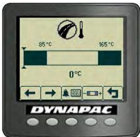
Se è installato il termometro asfalto (opzione), è anche possibile consultare un menu che riporta la temperatura dell'asfalto. Impostare i limiti superiore e inferiore di temperatura con i tasti funzione.
