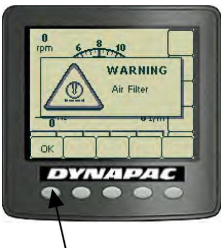
Una volta attivato un allarme di macchina, esso viene visualizzato nella schermata con un testo di avvertenza che lo descrive.
