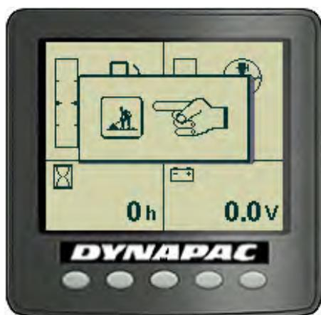
Se si cerca di attivare il tagliabordi (opzione) mentre la macchina è ad alta velocità, il display mostra la modalità a bassa velocità per alcuni secondi.
