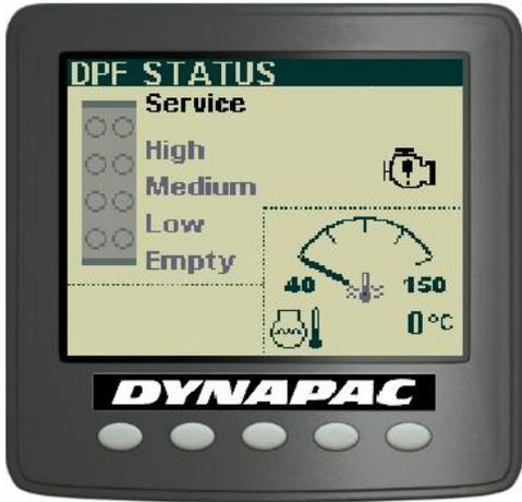
Attenzione! Se l'accumulo nel DPF raggiunge il livello massimo (Assistenza), l'apparecchiatura si blocca e il sistema non è in grado di auto-rigenerarsi. In queste condizioni, la pulizia del filtro può essere eseguita solo manualmente da un tecnico specializzato Cummins.
