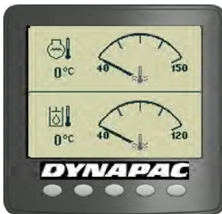
La schermata della temperatura mostra la temperatura dell'olio motore (parte superiore della schermata) e dell'olio idraulico (parte inferiore della schermata). I valori vengono visualizzati in gradi Celsius o Fahrenheit, a seconda delle unità di misura scelte.
