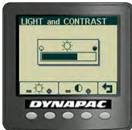
Regolazione delle impostazioni di luminosità e contrasto sul display, inclusa la luminosità del pannello.
