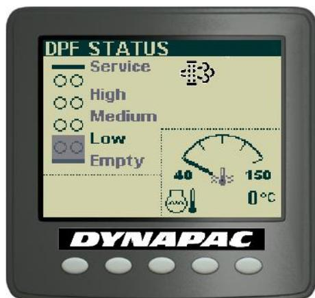
Quando l'accumulo nel DPF raggiunge il livello di contaminazione Basso, l'avvertenza di rigenerazione viene visualizzata ad indicare che la macchina avvierà la rigenerazione automatica non appena verrà fermata.
