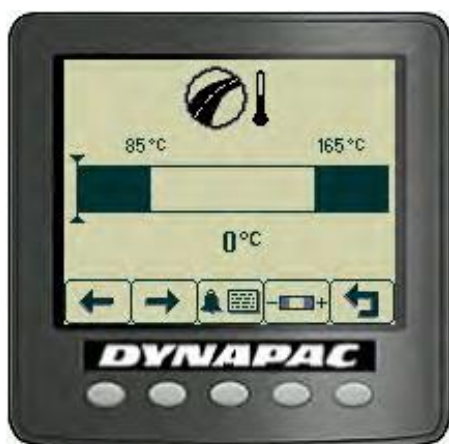
Fig.: Pantalla de temperatura del asfalto
