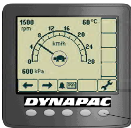
Fig. – Pantalla principal de funcionamiento con los botones de selección de los menús
