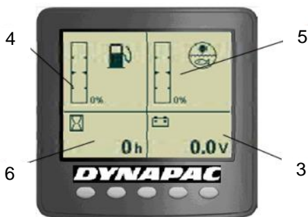
Fig.- Tela de estado 3. Voltímetro 4. Nível de combustível 5. Nível de água 6. Horímetro
