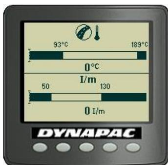
Fig. Tela de temperatura do asfalto/Impactômetro
