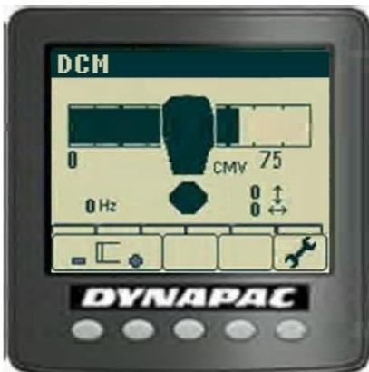
La información analizada se presenta en el monitor como un valor digital expresado en CMV (Valor del medidor de compactación). El rango de medición alto o bajo se selecciona automáticamente y se muestra en el monitor. El valor numérico resultante es una medida relativa de la rigidez de superficie obtenida.
