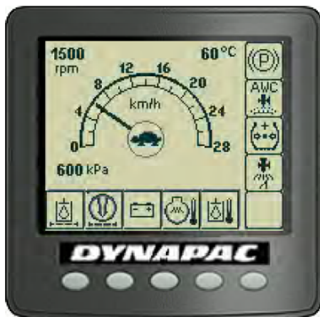
Fig. – Pantalla principal de operación
