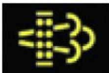
Acende-se quando o sistema é incapaz de completar a limpeza automática do sistema de exaustão. Operador deve assegurar que o botão de inibição não está acionado. Com esse alerta o operador pode continuar operando o equipamento e deve realizar a limpeza do sistema assim que possível.
