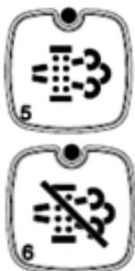
O interruptor permanece na posição neutra padrão durante operações normais. Isto significa que a limpeza do sistema de exaustão está acionado no modo automático. A limpeza é iniciada automaticamente por um temporizador predefinido em intervalos de 20 horas e leva cerca de 15-30 minutos para ser concluído. Não é necessária nenhuma ação do operador e o equipamento continua a trabalhar normalmente durante a limpeza.
