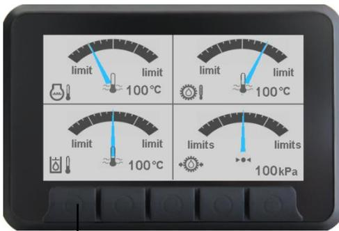
Na tela inicial de visão geral, aperte duas vezes o botão de seleção (1) para mostrar a tela das temperaturas e das pressões, que indica a temperatura do óleo do motor (parte superior esquerda), da transmissão (parte superior direita), do óleo hidráulico (parte inferior esquerda) e a pressão do óleo da transmissão (parte inferior direita). Os valores são indicados em graus Celsius ou Fahrenheit e kPa ou PSI, dependendo da opção do sistema de medidas.
