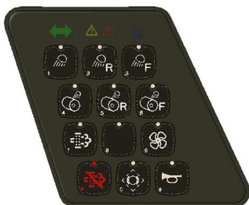
Fig. – O botão de inibição desativa a função de regeneração.
