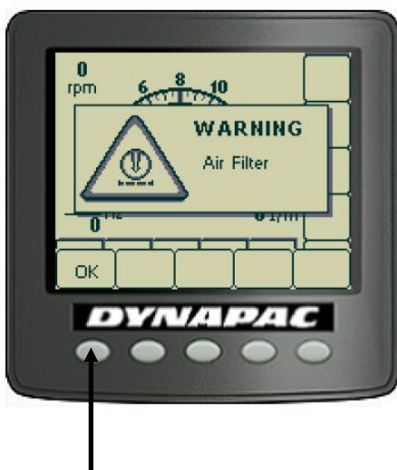
Fig. – Telas de alarme do motor e da máquina
