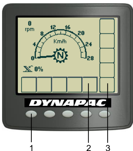
Fig. – Tela principal de operação com os botões de seleção dos menus
