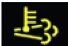
Acende-se se durante o processo de limpeza do sistema de exaustão o sensor reconhecer alta temperatura. O operador deve assegurar que a saída do tubo de escape não está dirigida a superfícies inflamáveis ou combustíveis.
