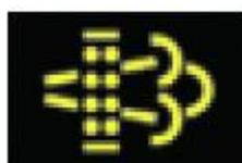
Acende-se intermitentemente quando a limpeza do sistema de exaustão é iniciado através do botão. Esta lâmpada continuará a piscar até que se conclua a limpeza do sistema. Uma vez que a lâmpada desliga, o operador pode retomar a atividade normal de trabalho.
