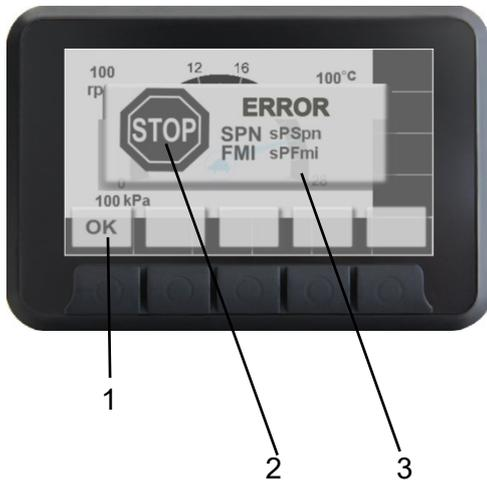
Quando o módulo eletrônico detecta um problema relacionado ao controle da transmissão ou do motor, a tela multifunções alertará o operador através de uma mensagem com o símbolo (2) e o código FMI e SPN (conforme DM1 - SAE J1939) do erro (3), e a máquina será impedida de movimentar-se normalmente, entrando no modo de movimentação de emergência (ver interruptor transporte de emergência na página 10).
