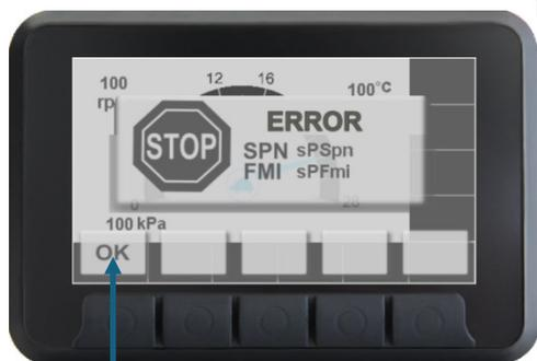
Quando um alarme do motor ou da transmissão é ativado, a indicação aparece na tela. O alarme é emitido pelos controles do motor e da transmissão, que fazem o monitoramento de suas funções.
