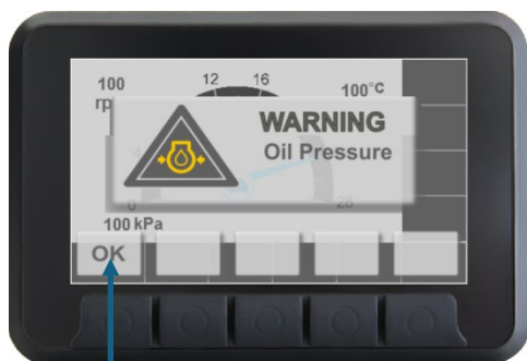
Fig. – Telas de alarme da máquina
