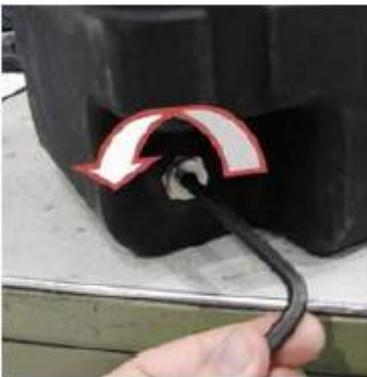
Usando la llave Allen de 1/4" desenrosque el tapón de drenaje del tanque de DEF girándolo en sentido antihorario. Coloque el tapón de drenaje en un lugar libre de intemperies.
