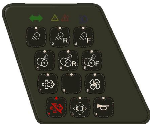
Fig. - El botón de inhibición inhabilita la función de regeneración.
