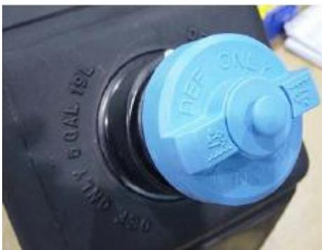
Limpie la tapa y la entrada de DEF para evitar la entrada de residuos en el tanque.
