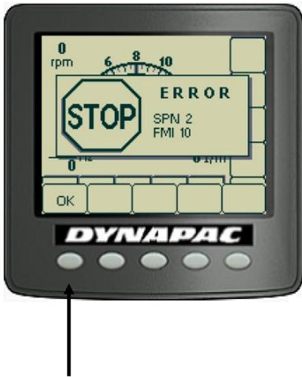
Cuando se activa una alarma del motor o de la transmisión, aparece la indicación en la pantalla. La alarma se emite por los controles del motor y de la transmisión, que hacen el seguimiento de sus funciones.
