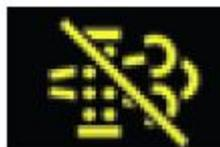
**Alerta de inhibición de limpieza del Sistema de escape.**
