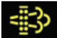
**Alerta de limpieza del Sistema de escape con alerta de verificación del motor.**
