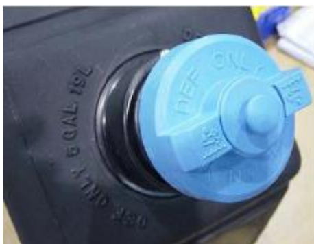
Fig. Tanque DEF 3. Tapa cerrada
