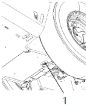
*Fig. Depósito hidráulico*
