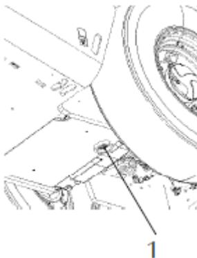
**Fig. Deposito hidráulico, fondo
