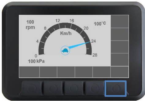
Fig. – Pantalla principal de operación con los botones de selección de los menús
