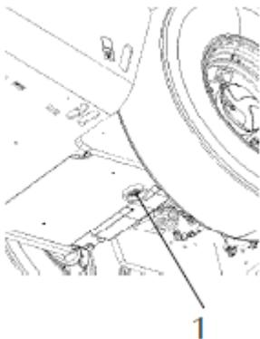
**Fig. Deposito hidráulico, fondo**
