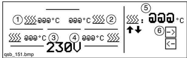
La temperatura de la calefacción puede ser leída en este subpunto de menú para los siguientes elementos de regla, y puede ser regulada comúnmente para todos los elementos de la regla:
