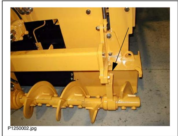
Al ser efectuado el ensanchamiento del tornillo sinfín deberían ser aflojados un poco los anillos exteriores al ser engrasados los puntos exteriores de cojinetes, a fin de garantizar una mejor ventilación al realizarse el engrase.
