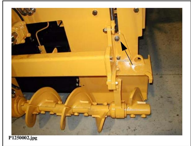
Per l'ampliamento della coclea, nel primo ingrassaggio dei punti di cuscinetto esterni occorre allentare leggermente gli anelli esterni per garantire una migliore ventilazione durante la lubrificazione.
