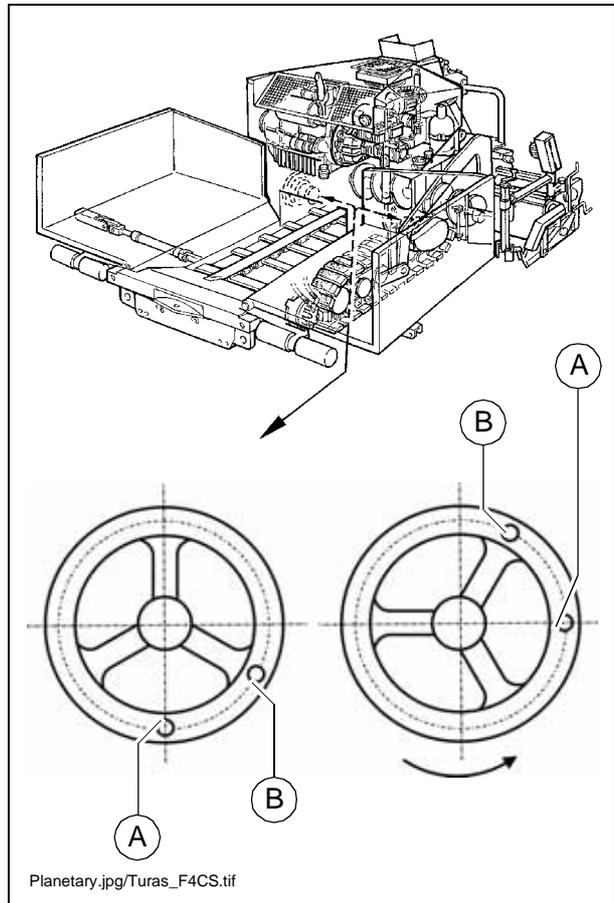
Encha com óleo até ao orifício de enchimento (1), enrosque o parafuso de ventilação (2) e de sangria (1).
