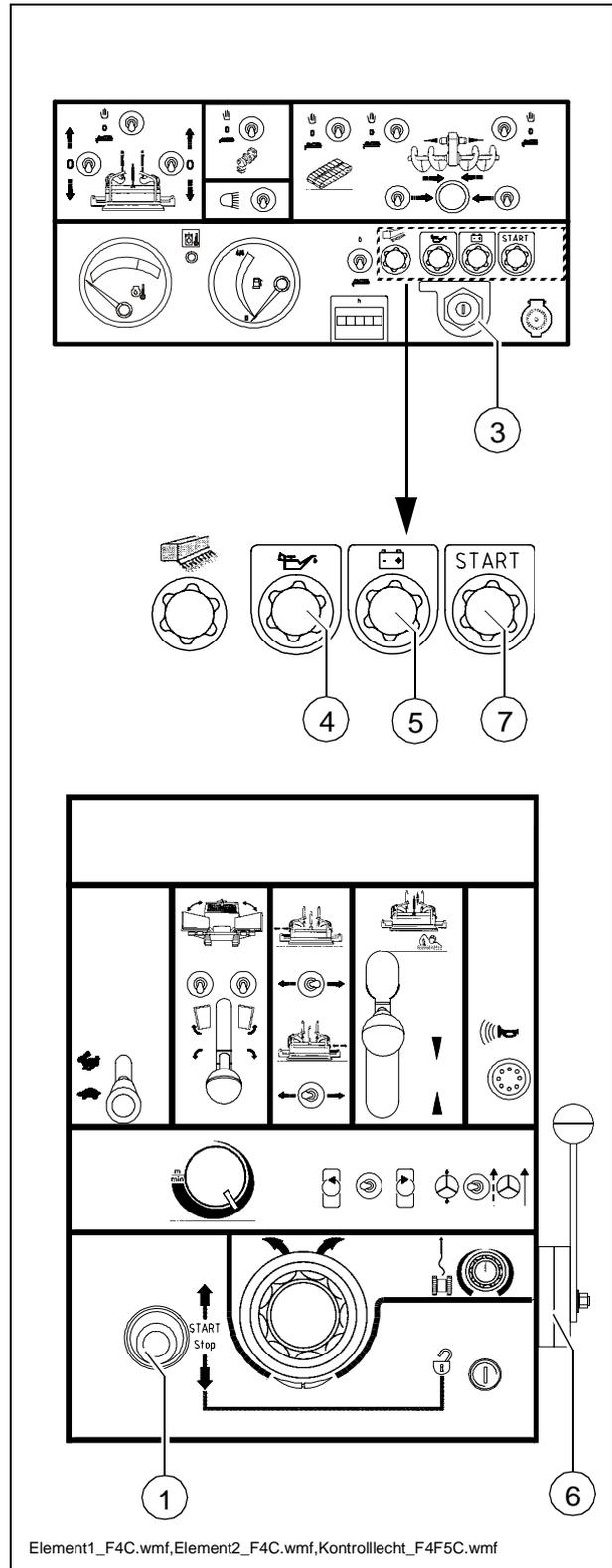
m Se a luz de controlo da pressão do óleo do motor (4) não se apagar após o arranque, desligue imediatamente o motor e verifique o nível do óleo do motor.
