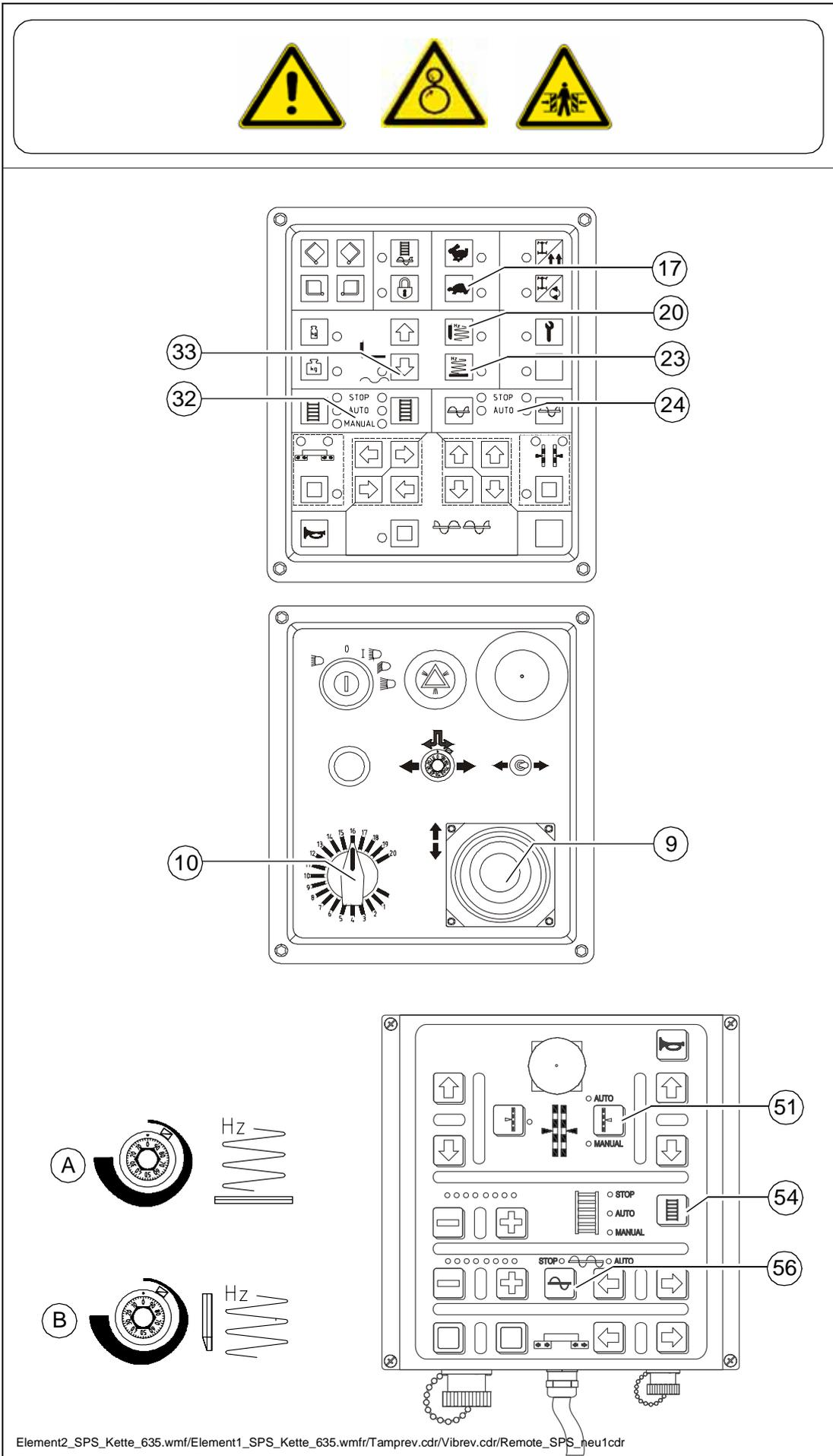
Quand la table a atteint la température de l'enrobé et il y a assez de mélange devant la table, les interrupteurs, leviers et régulateurs doivent être mis dans la position indiquée
