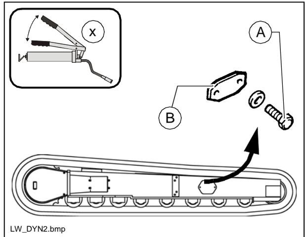
A La chaîne est convenablement tendue lorsque le fléchissement (F) entre le galet de roulement central et la chaîne est de 30-40 mm.
