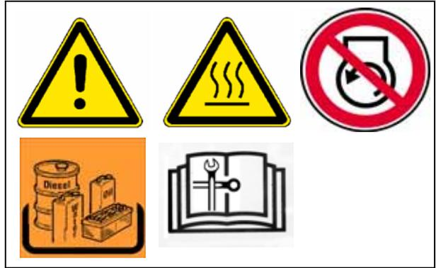
f En état chaud le système est sous pression. Risque de brûlures lors de l'ouverture!
