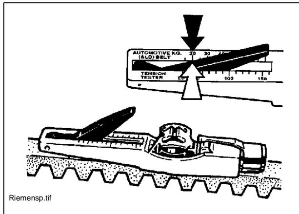
A Les instructions pour mesurer la tension se trouvent dans la description de l'instrument de mesure de la tension !
