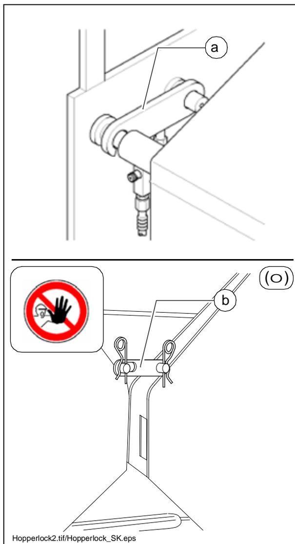
**La sécurisation mécanique du transport de la table de pose (en-dessous et à droite du siège du conducteur) (74)**
