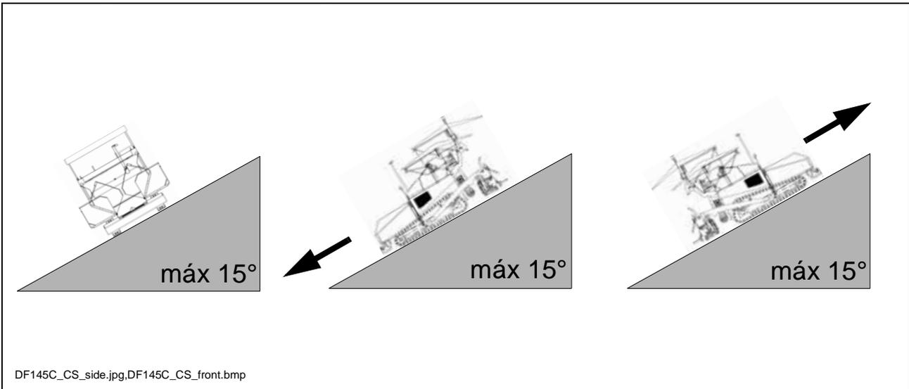
A ¡Antes de la operación de la máquina en posiciones inclinadas (rampas, pendientes, inclinación lateral) más allá del valor indicado debe consultarse el servicio técnico para su máquina!
