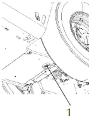
**Fig. Reservatório hidráulico**
