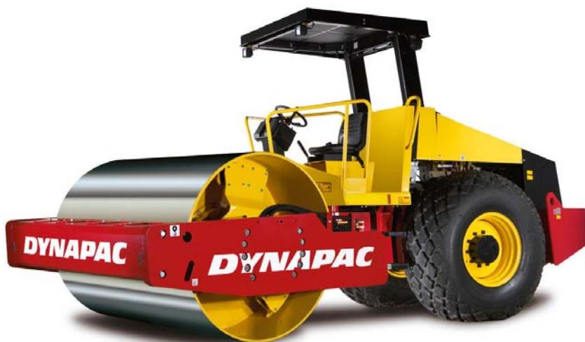
Dynapac CA250 este un cilindru compactor din clasa 11 tone. CA250 este disponibil atât în varianta STD, D (lis) și P (crampoane), cât și PD (picior de oale). Versiunile P și PD se utilizează în principal pentru materialele coeziive și piatră expusă la intemperii.
