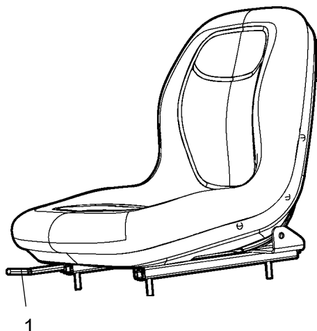
Рис. Сиденье оператора 1. Продольная регулировка
