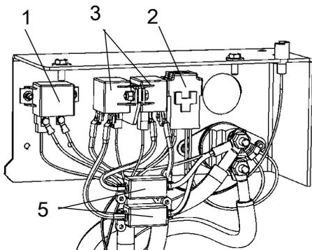
Hay dos fusibles principales (2). Se encuentran detrás del interruptor de desconexión de la batería. Los dos tornillos deben aflojarse para retirar la cubierta de metal.
