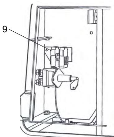
**Fig. Conmutador de desconexión de la batería/caja de fusibles del compartimento del refrigerador.**
