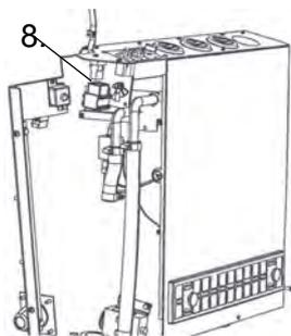
**Fig. Caja del calentador en la cabina.**
