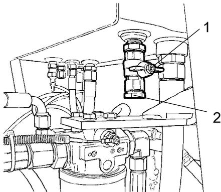
**Fig. Depósito hidráulico, parte inferior**
