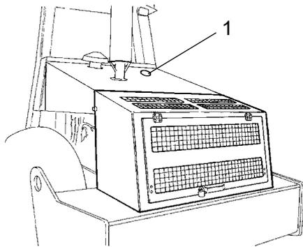
**Fig. Rejilla del refrigerador**
