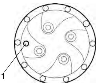
**Fig. Comprobación del nivel - planetario, opcional**
