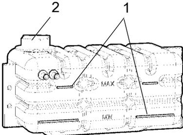
**Fig. Depósito de refrigerante**
