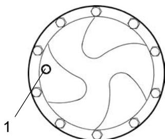
**Fig. Controllo del livello nel riduttore planetario standard**
