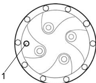
**Fig. Rabbocco dell'olio nel riduttore planetario opzionale**
