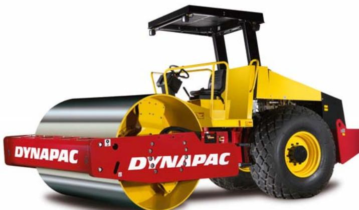
CA280, Dynapac'in orta-ağır toprak sıkıştırma silindirlerinden biridir. STD ve D sürümlerinde mevcuttur.
